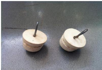
图 C.2 橡皮塞的处理
